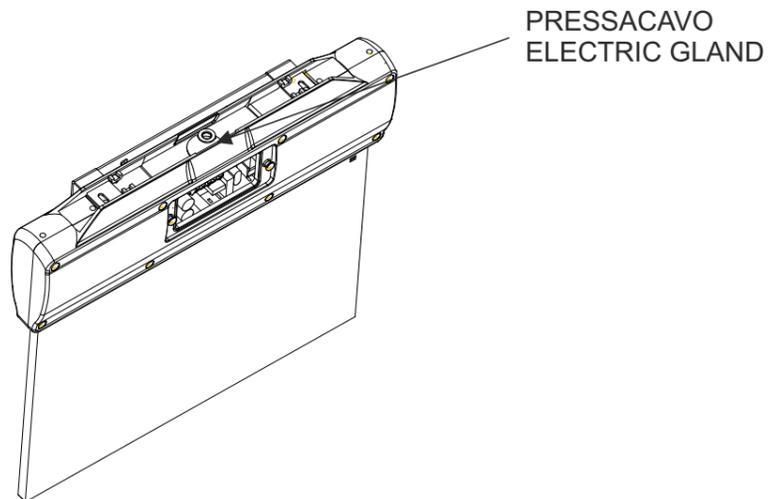
**⚠** RISPETTARE LE INDICAZIONI FORNITE IN QUESTA ISTRUZIONE PER NON PERDERE IL GRADO DI PROTEZIONE IP 65
